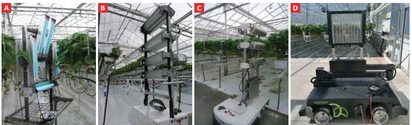
Overzicht van de evolutie van het uv-C-toestel van 2010 tot 2021: de oogstkar met lampen (A) werd een prototype aangestuurd met een afstandsbediening (B), dan een prototype aangestuurd met de smartphone (C) en uiteindelijk een volledig autonoom toestel (D).
